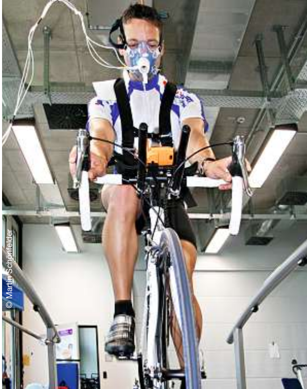
Labortest unter Praxisbedingungen: Analyse der Sauerstoffaufnahme und Ausdauerleistungsfähigkeit auf dem Rennrad
